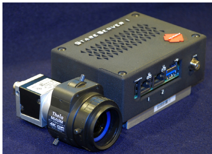
StareServer 1 – сервер в компактном корпусе (11 см в длину) с камерой Basler ace U acA4024-29um с объективом высокого разрешения.
