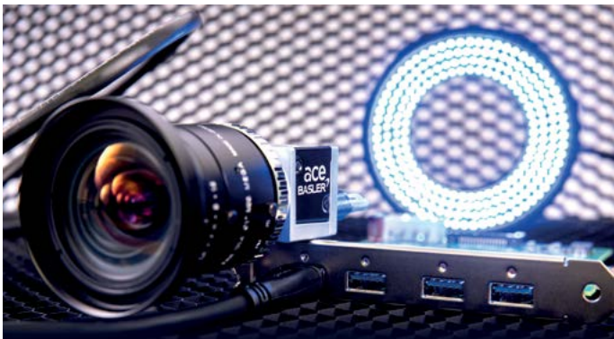
그림: 조명은 비전 시스템에서 중요한 역할을 합니다. 조명은 다른 이미지 처리 구성 요소와 함께 우수한 이미지 품질을 보장하는 데 필요한 빛을 제공하고 간섭하는 물체를 숨기거나 기계 감지를 위해 물체의 가시성을 높입니다.
