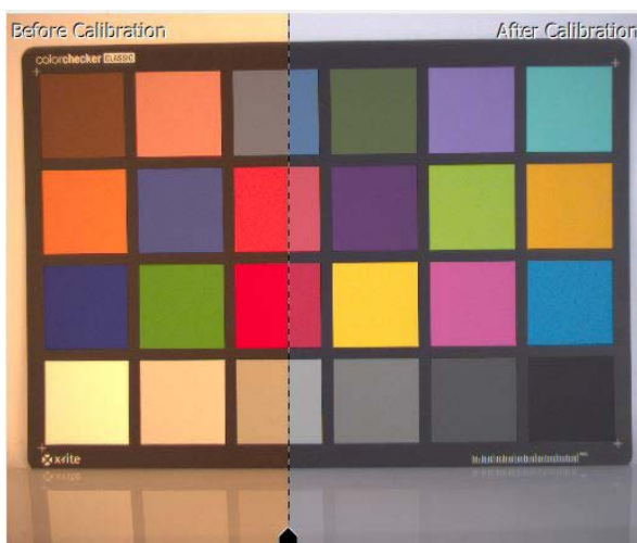
図3：カラーキャリブレーションツール - カメラの迅速かつスムーズなキャリブレーションが可能な色補正機能。画像は、キャリブレーション前（左）とキャリブレーション後（右）を比較したものです。カラーキャリブレーションツールを使用した後は黄色成分が抑えられ、背景もより白く表示されているため、色の違いがはっきりとわかります。
