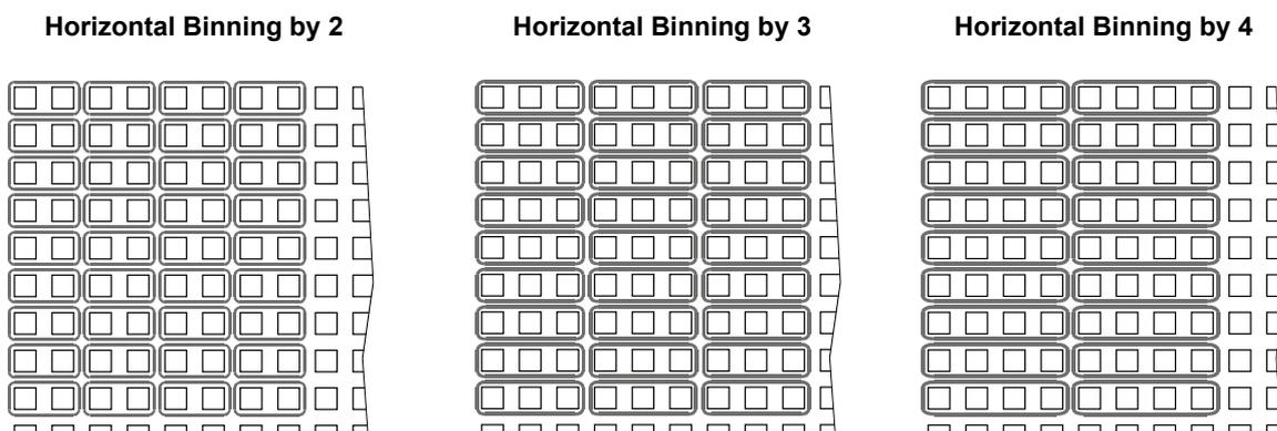
Fig. 73: Horizontal Binning
