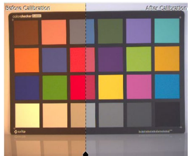
Bild 3: Color Calibration Tool - Das Color Calibration Tool ermöglicht eine schnelle und einfache Farbkalibrierung der Kamera. Im Bild ist der Vorher-Nachher Vergleich nach Kalibrierung gezeigt. Der Gelbstich vor der Kalibrierung ist nach der Anwendung des Color Calibration Tools sichtbar verschwunden; der Hintergrund ist deutlich weißer und die Farben in den Feldern kräftiger.
