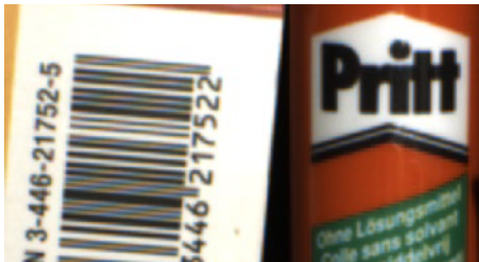
图5: 2×2去拜耳化造成的颜色误差, 可以清楚地条形码中观察到
