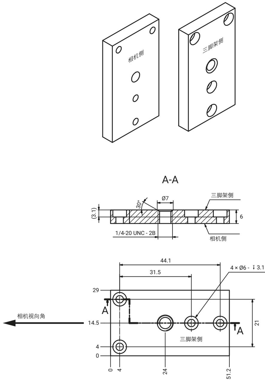
图 1：三脚架座尺寸（未按比例，单位：mm）
