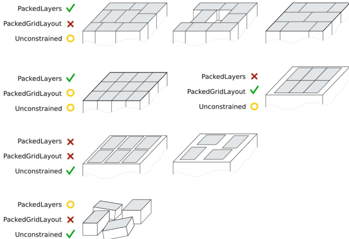
Abb. 6.17: Darstellung geeigneter BoxPick Modi für unterschiedliche Szenen. Gelb markierte Modi sind anwendbar, aber nicht empfohlen für das jeweilige Szenario. Die grauen Flächen markieren die Rechtecke, die erkannt werden sollen.
