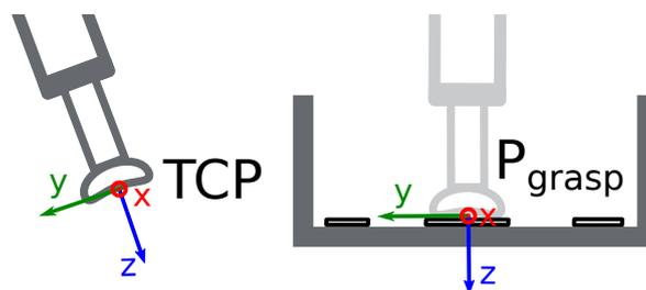
Abb. 6.18: Definition von Greifpunkten bezogen auf den Roboter-TCP
