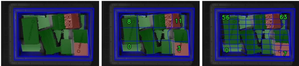
Abb. 6.10: Visualisierungen des Behälterfüllstands: Gesamtfüllstand ohne Raster (links), 4x3 Raster (Mitte), 8x8 Raster (rechts). Der Inhalt wird mit einem Farbverlauf von weiß (auf dem Boden) nach dunkelgrün dargestellt. Die überfüllten Bereiche sind rot dargestellt. Die Nummern stellen die Zell-IDs dar.
