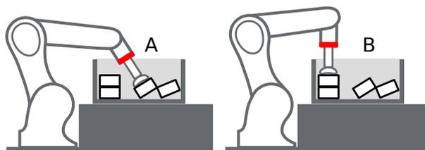
Abb. 6.45: Fall A: Der Griff wird nur als Kollision erkannt, wenn `check_flange` auf `true` gesetzt ist, denn der Flansch (rot) befindet sich im Load Carrier. Fall B: Der Griff ist in jedem Fall kollisionsfrei.
