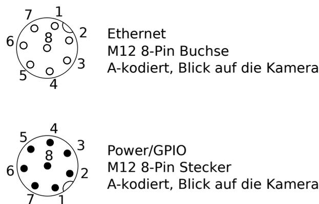
Abb. 3.5: Steckerbelegung für den Strom- und Ethernetanschluss
