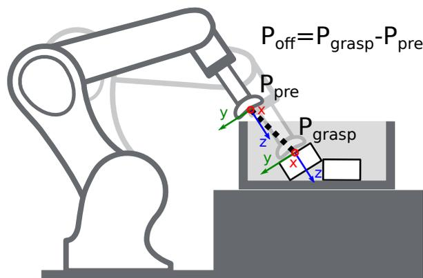
Abb. 6.30: Darstellung des Greif-Offsets für die Kollisionsprüfung. Im dargestellten Fall sind sowohl die Vorgeifposition als auch die Greifposition kollisionsfrei, aber die Trajektorie zwischen diesen Punkten hätte eine Kollision mit dem Load Carrier. Deswegen wird dieser Greifpunkt als Kollision erkannt.
