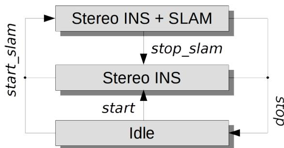
Abb. 6.6: Vereinfachtes Zustandsdiagramm
