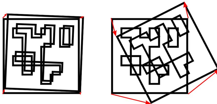
Abb. 6.15: Vereinfachte Darstellung der Tag-Wiedererkennung. Die euklidischen Abstände zwischen zusammengehörigen Tagecken in 3D werden berechnet (rote Pfeile).
