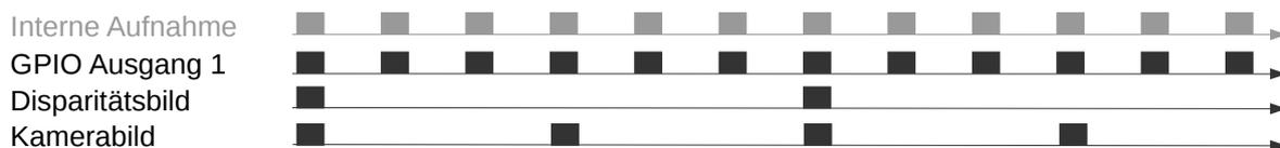
Abb. 6.38: Beispiel für die Nutzung der Betriebsart ExposureActive für GPIO-Ausgang 1 mit einer benutzerdefinierten Bildwiederholrate von 8 Hz. Die interne Bildaufnahme geschieht immer mit 25 Hz. GPIO-Ausgang 1 ist für die Dauer der Belichtungszeit jedes Bildes *an* (HIGH). Disparitätsbilder werden für Kamerabilder berechnet, die auch per GigE Vision in der benutzerdefinierten Bildwiederholrate versendet werden.
