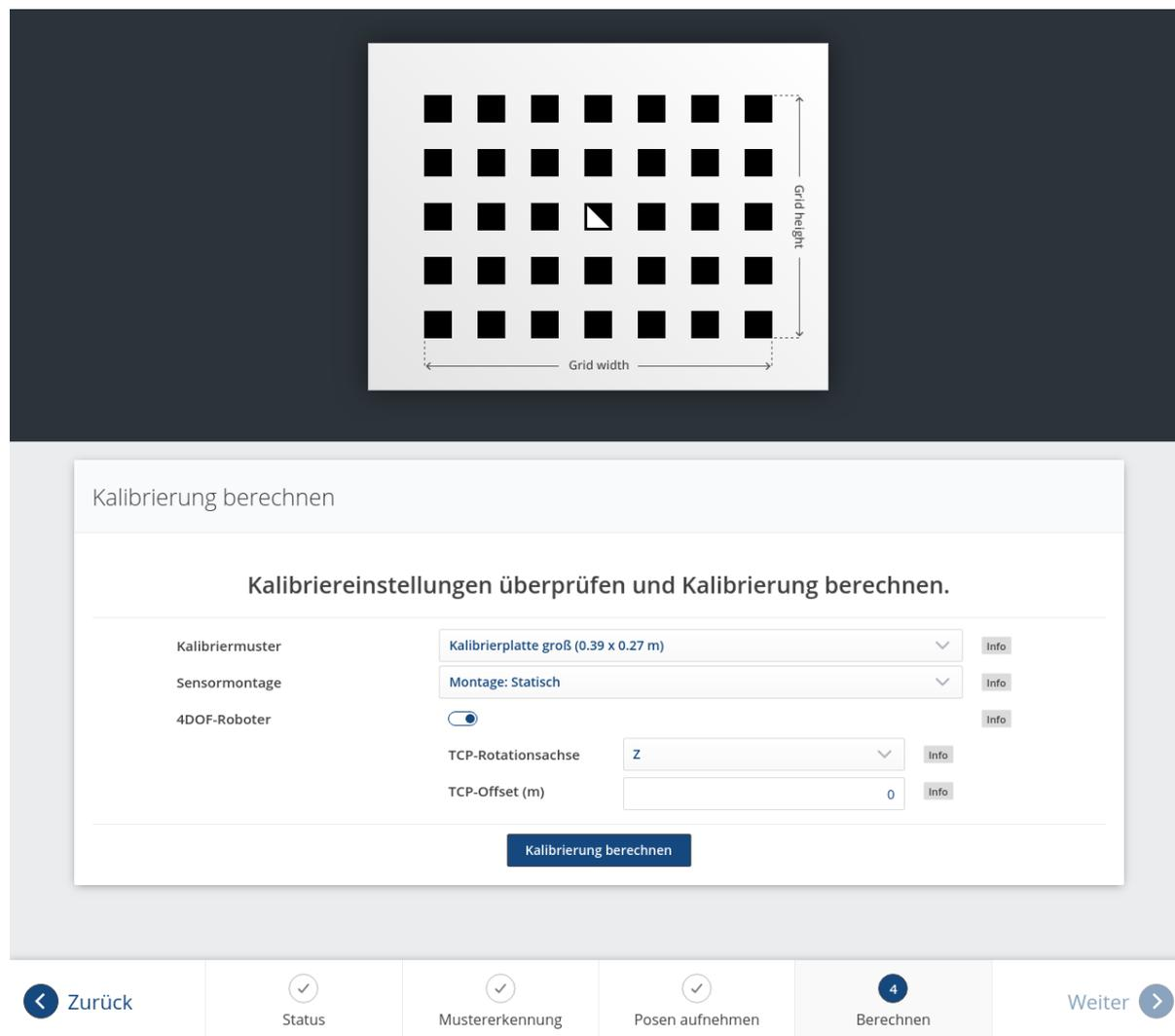
Abb. 6.29: Setzen der Parameter und Berechnen der Hand-Auge-Kalibrierung in der Web GUI des *rc\_visard*
