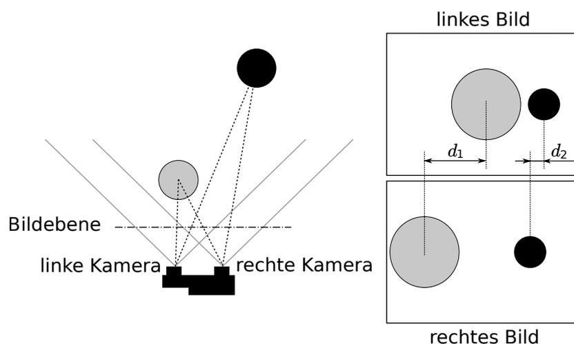
Abb. 5.1: Schematische Darstellung des Prinzips der Stereovision: Die Disparität  $d_2$  des weiter entfernten (schwarzen) Objekts ist kleiner als die Disparität  $d_1$  des nahe liegenden (grauen) Objekts.
