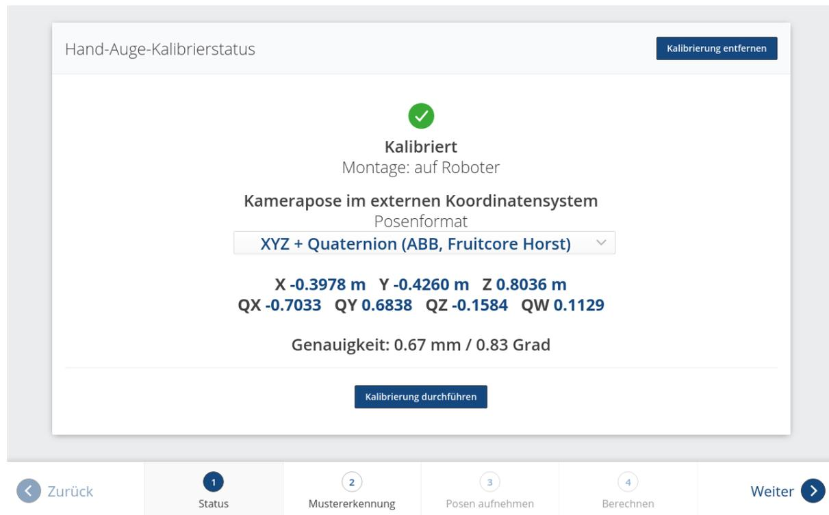
Abb. 6.25: Aktueller Status der Hand-Auge-Kalibrierung falls eine Hand-Auge-Kalibrierung gespeichert ist
