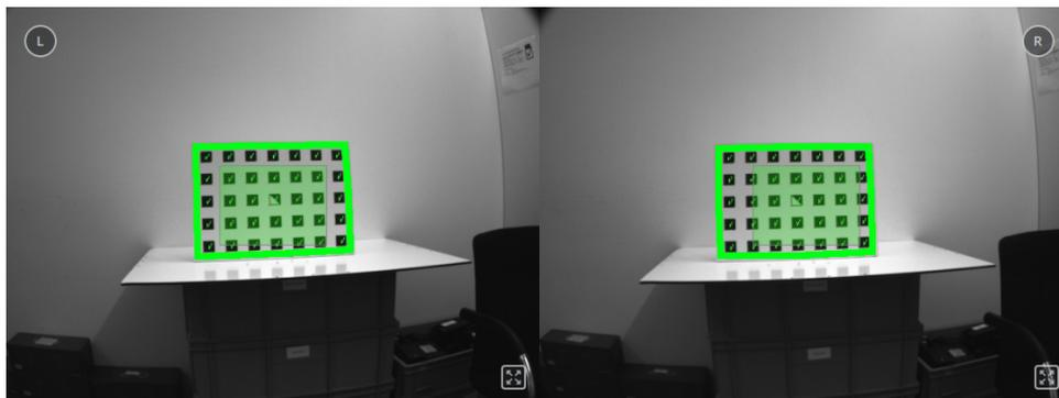
Abb. 6.35: Positionierung des Musters so entfernt wie möglich während der Stereokalibrierung
